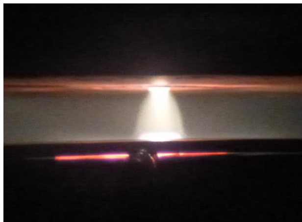
Рис. 2. Сверхзвуковая плазменная струя, взаимодействующая с молибденовой подложкой. Давление в газоразрядной камере 21000 Па, давление в вакуумной камере 600 Па. Диаметр сопла 3 мм. Расход аргона 4000 нсм 3 /мин, расход водорода 1000 нсм 3 /мин, расход метана 18 нсм 3 /мин. Мощность СВЧ разряда 1 кВт.
