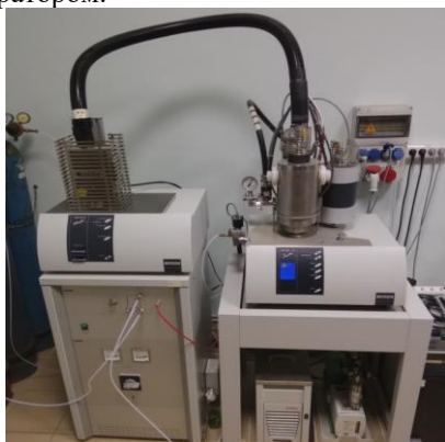
Рис. 1. STA 449F1 Jupiter® совмещенный с QMS 403D Aëolos.
