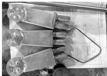
Рис. 1. Датчики теплового потока, установленные в головку термозонда.
