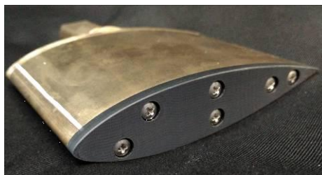
Рис. 1. Фотография гидрокрыла серии НАСА 0022-34 с установленным гибким турбулизатором вблизи передней кромки.
